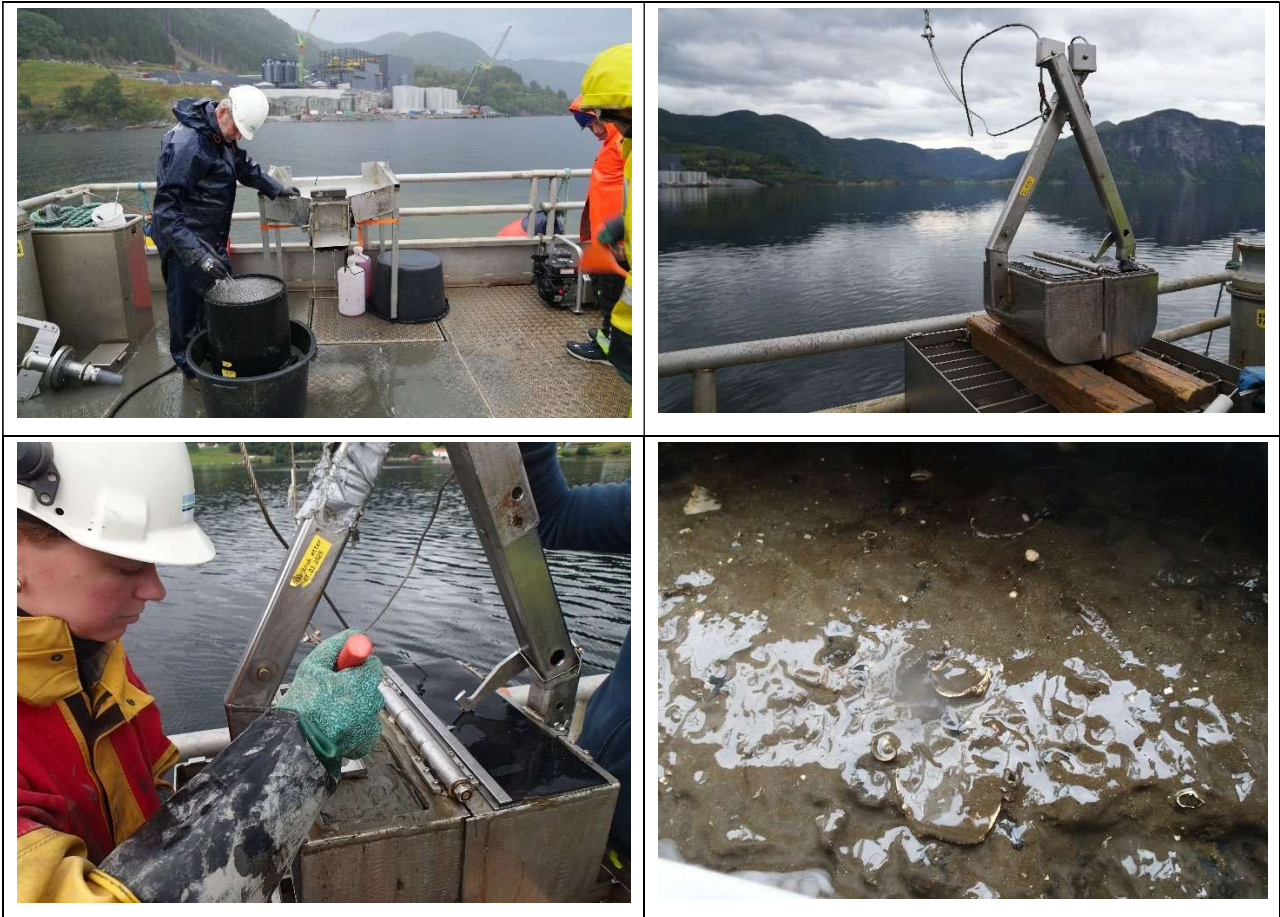
Figur 3-2. Bilder fra feltarbeidet august 2024. Øverst til venstre: mottaksbord og siktesett. Øverst til høyre: van Veen grabb. Nederst til venstre: uttak av prøver til kjemiske analyser. Nederst til høyre: overflatesediment fra FB22.
