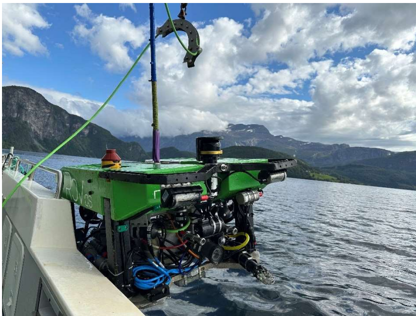
Figur 4-2 ROV (ROV as) benyttet til de visuelle kartleggingene i Førdefjorden
